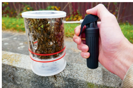
Figure 4 : Du CO 2 est injecté dans le récipient du Varroatester, ce qui endort les abeilles. (Photo : Agroscope-CRA)
