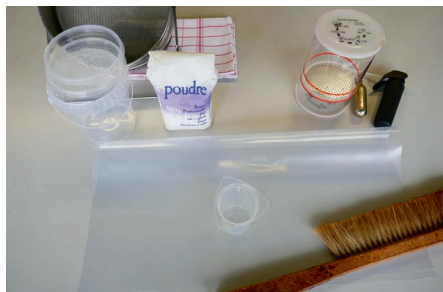
Figure 2 : Matériel nécessaire pour la mesure du taux d'infestation par varroa avec les deux méthodes : sucre glace (en haut à gauche), CO 2 avec le Varroatester (en haut à droite). (Photo : Agroscope-CRA)
